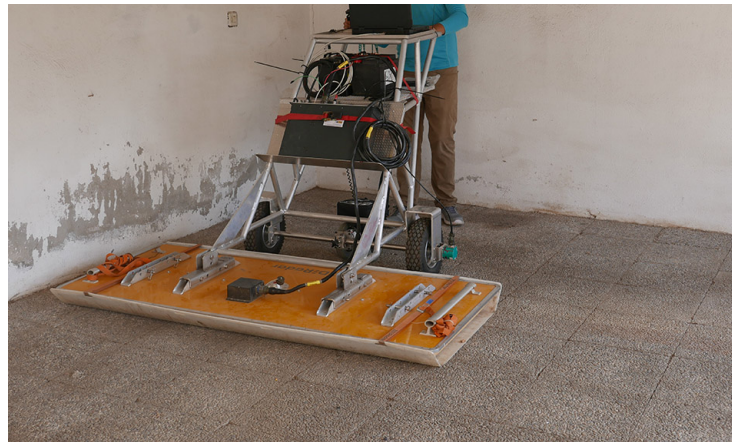
Vehículo eléctrico para georrádar multicanal
