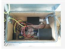
La sincronización de tiempo se realiza por medio de un **receptor de satélite GPS** y la comunicación con la estación central se establece a través de un MODEM adecuado para el tipo de enlace en cada caso.
