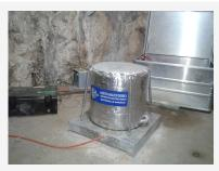
Las estaciones de banda ancha están instaladas en **cuevas naturales o túneles**, para asegurar un ambiente estable en temperatura y disminuir el ruido superficial. El sensor se aísla además con una cubierta térmica.
