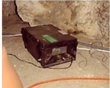
El **Instituto Andaluz de Geofísica** ha comenzado la remodelación de su red sísmica con la incorporación de 4 acelerógrafos del tipo **Terra Technology 3602A** de 16 bits de resolución y 132 dB de margen dinámico, 6 acelerógrafos Kinematics de 18 bits tipo **ETNA** y 3 GURALP CMG-eTD. Algunos de estos equipos se encuentran completando las estaciones de banda-ancha.
