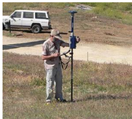
GPS móvil levantando puntos para un perfil geofísico
