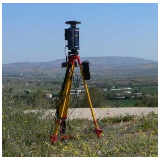
Base GPS calibrada para funcionar con un sistema de coordenadas local
