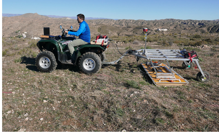
Sistema para arrastre del georrádar multicanal
