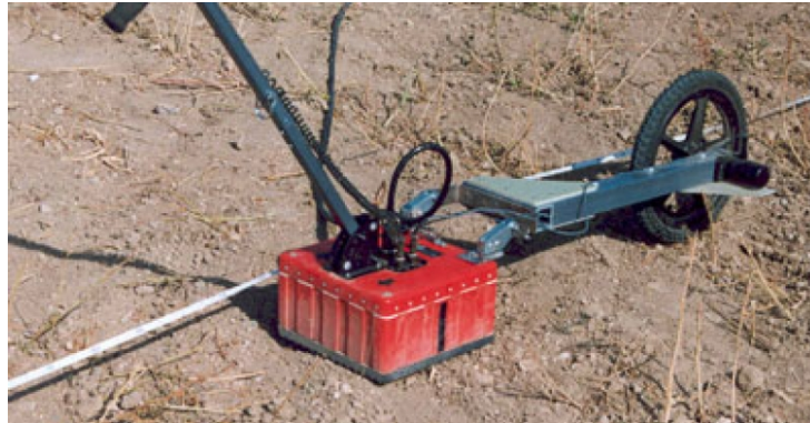
Antena monostática apantallada de 400 MHz
