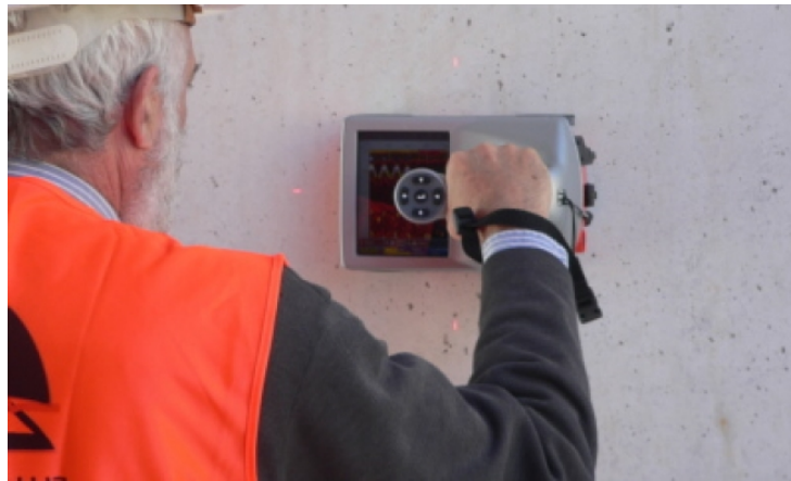
3D StructureScan mini de 1.6 GHz
