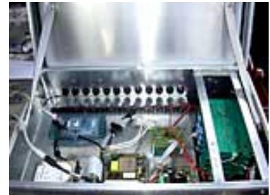
Los módulos de array basados las **placas SEISAD18** son sistemas diseñados por el Instituto Andaluz de Geofísica junto con la Universidad de Bergen (Noruega) y el Osservatorio Vesubiano (Italia) y que han sido fabricados por la empresa española sismiCAD, con las siguientes **características**:
